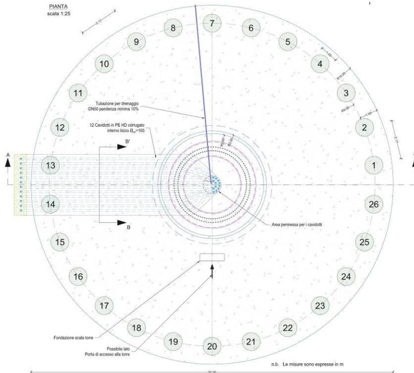
Fig.2 Pianta del plinto con indicazione dei pali di fondazione (n.26 del diametro 100 cm)
