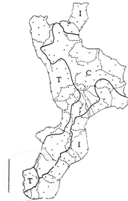
Figura 4.3: Suddivisione della Calabria in sottozone pluviometriche omogenee, al secondo livello di regionalizzazione
