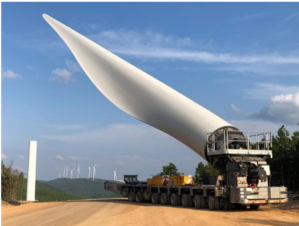
Foto 2 Trasporto pala mediante mezzo speciale blade lift
