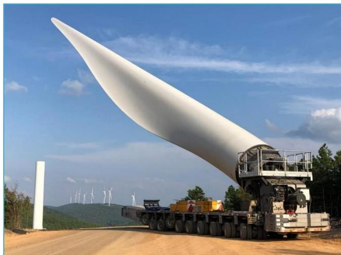
**Figura 3.12: Trasporto pala mediante mezzo speciale “blade lift”**
