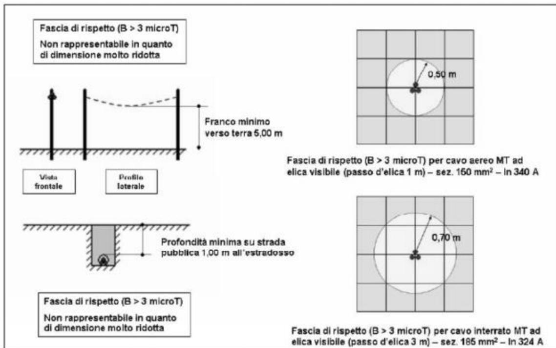
Nel caso delle Cabine di consegna, per ogni sottocampo è prevista l'installazione di un trasformatore da 100kVA. Nel caso di installazione di un trasformatore di potenza pari fino a 630 kVA, è necessario calcolare la DPA relativa. Con riferimento alla tabella B10 caso c, che si riporta in seguito, la DPA si estende per 2 metri rispetto al filo esterno della cabina.
