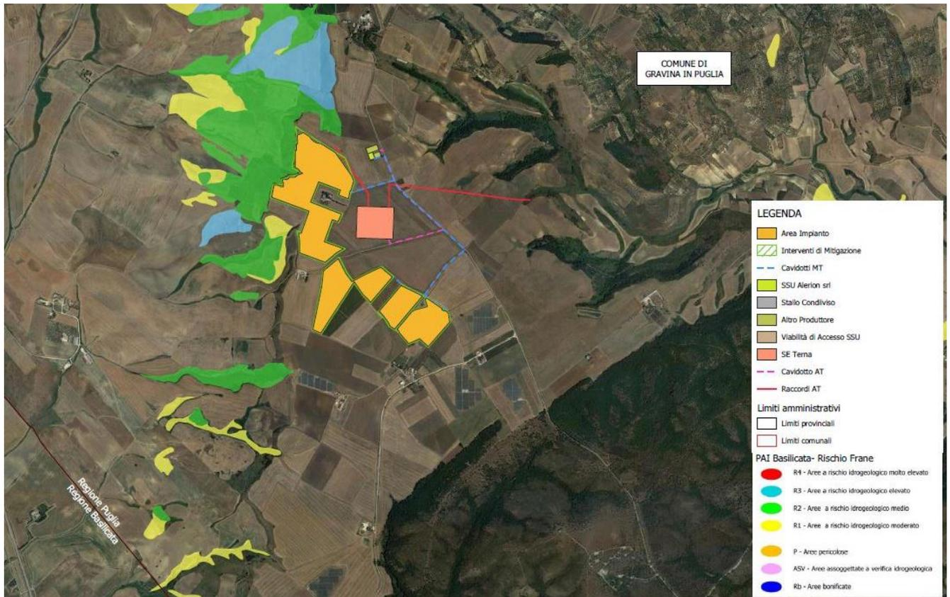
Figura 3-16: Estratto del Piano stralcio per la difesa dal rischio idrogeologico-Rischio frane nell'area di intervento e layout di progetto (agg. febbraio 2022)
