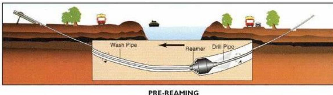
Il tracciato realizzato mediante tale tecnica consente in genere, salvo casi particolari, inclinazioni dell'ordine dei 12÷15 gradi. In genere la trivellazione viene eseguita ad una profondità di almeno 2 m sotto l'alveo dei corsi d'acqua mentre i pozzetti di ispezione che coincidono con quello di partenza e di arrivo della tubazione di attraversamento vengono realizzati alla quota del terreno.
