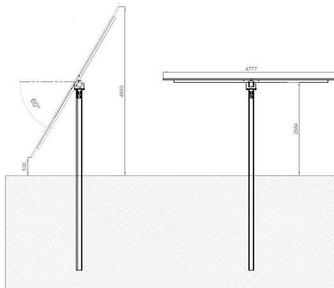
Figura 4-2: Sezione tipo struttura porta pannelli
