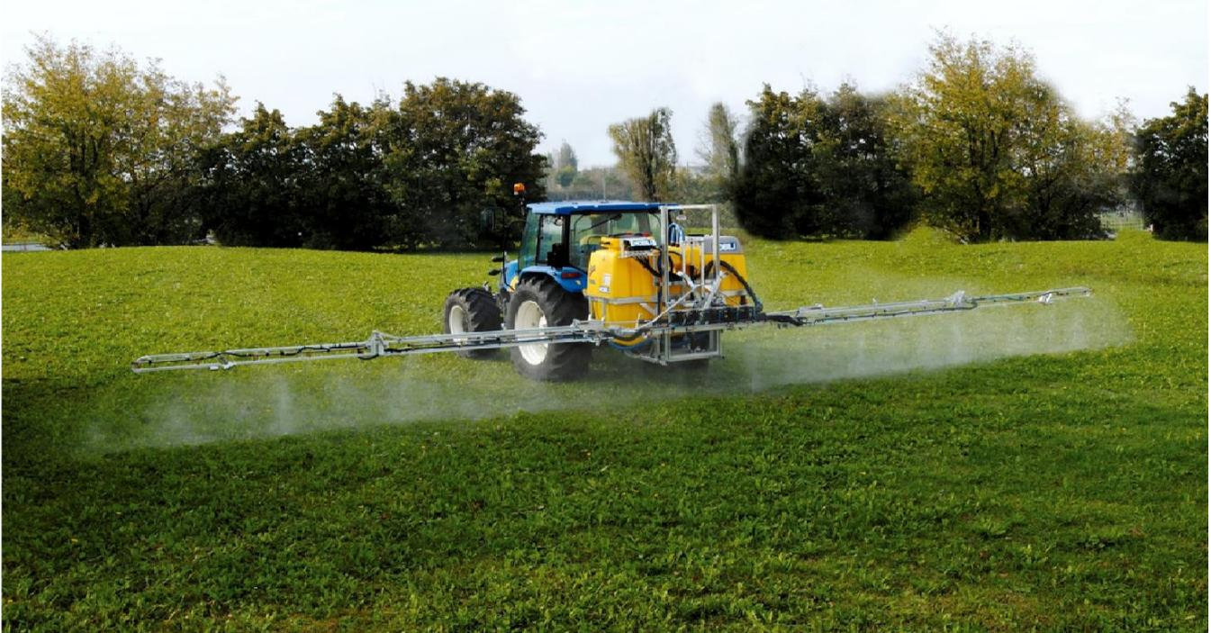
Figura 7 Barra irroratrice con ugelli antideriva
