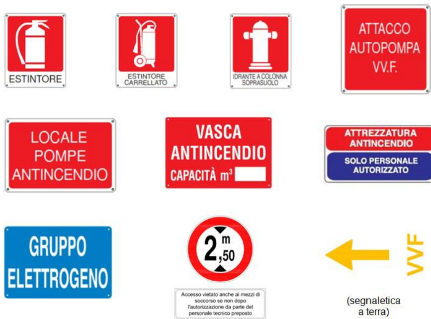
Figura 1 - Esempi di segnaletica di sicurezza
