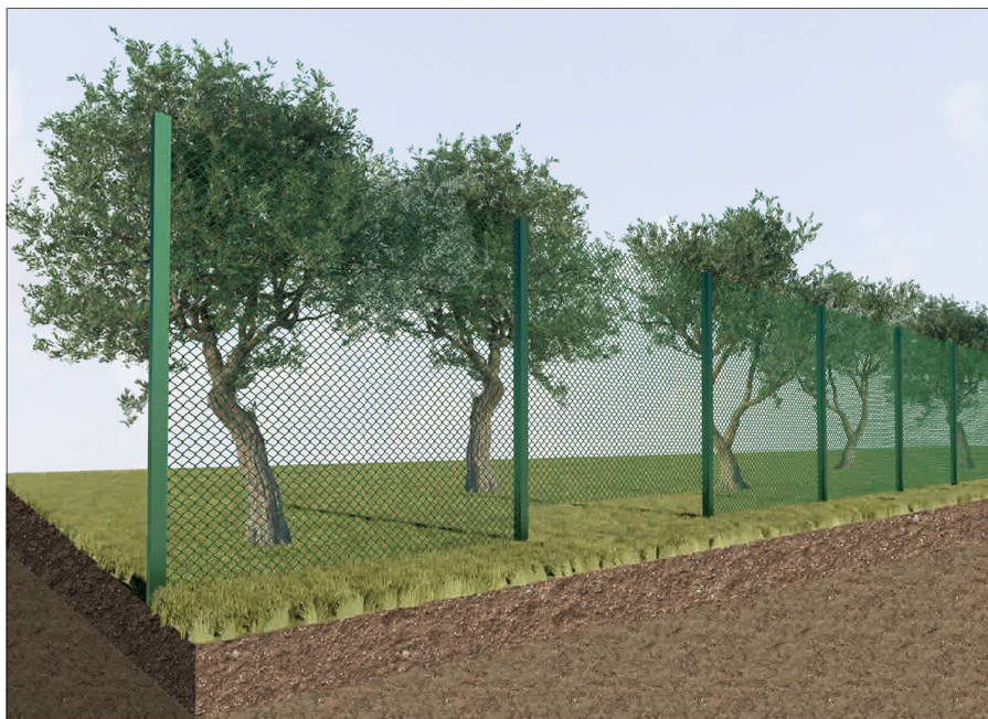
Figura 56: Particolare recinzione perimetrale con opere di mitigazione
