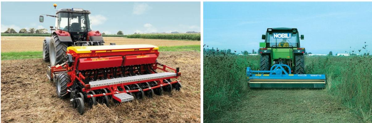
Figura 39: Esempio di seminatrice di precisione e di trinciature del manto erboso
