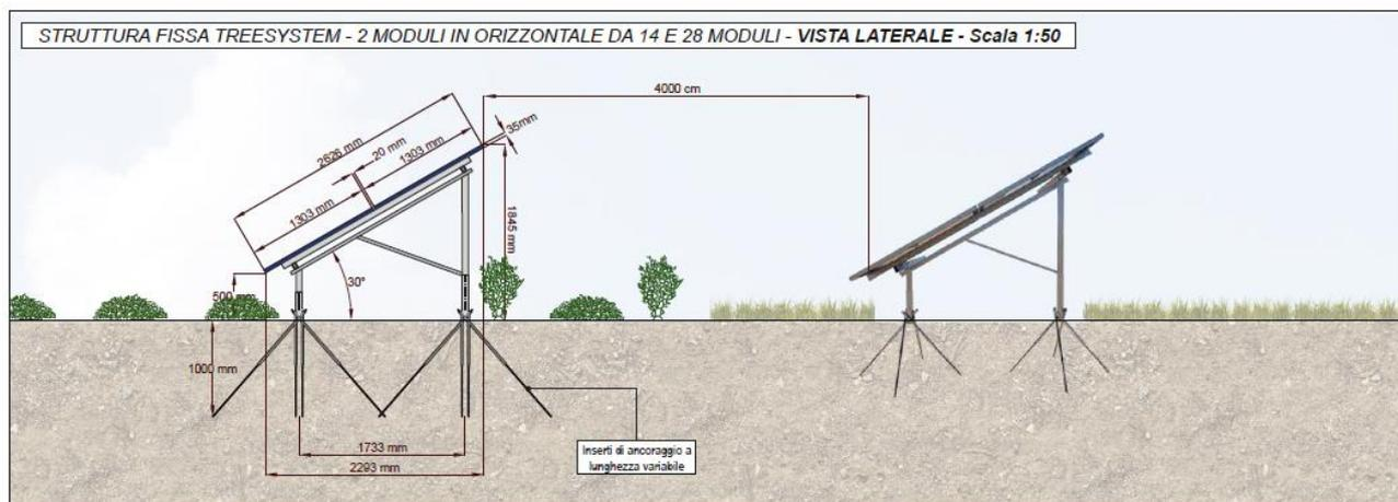
**Figura 2.3: Strutture porta moduli – vista laterale**
