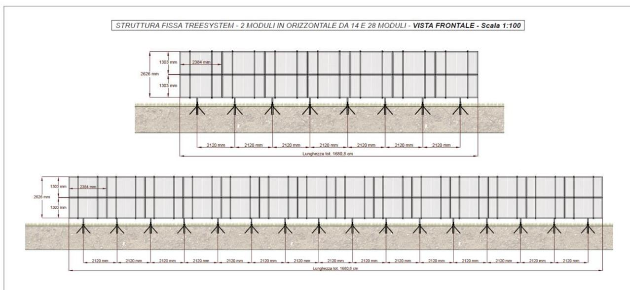
**Figura 2.4: Struttura porta moduli – vista frontale**
