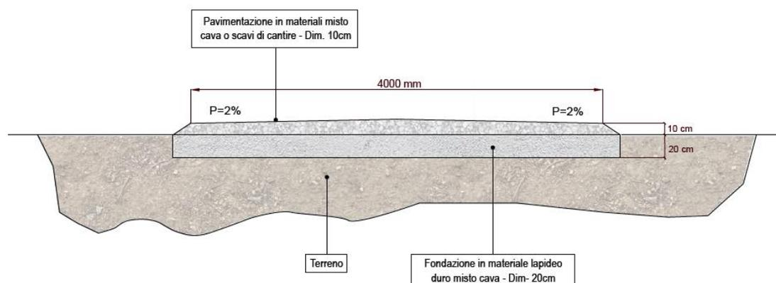
**Figura 2.11: sezione tipo viabilità interna**
