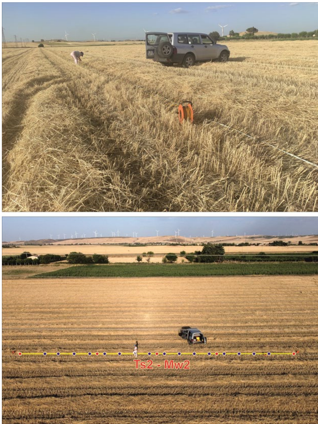
Figura 25 – Ubicazione dell'array sismico
