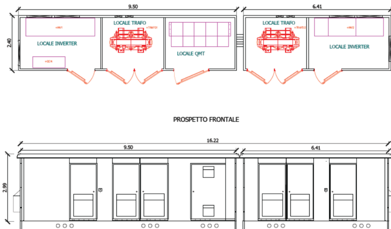
Figure 1: Pianta e prospetto cabina inverter trasformatore BT-MT 2.
