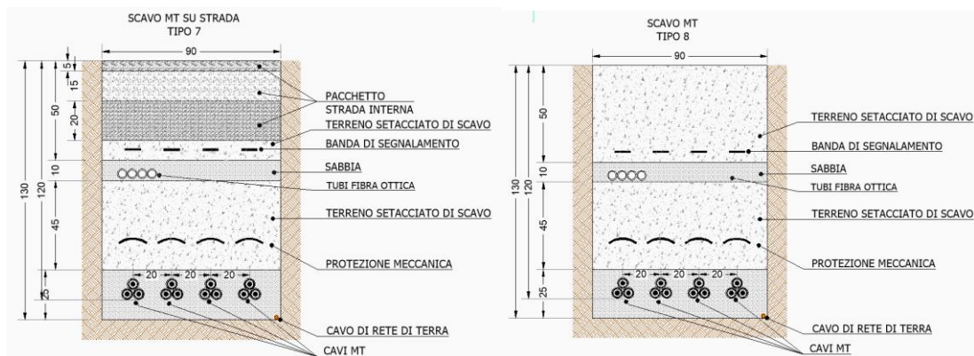
Figura 13: Esempi tipici scavo MT
