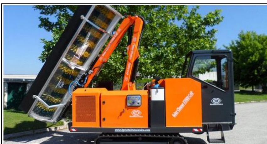
Figura 39: Macchina per pulizia a secco dei pannelli
