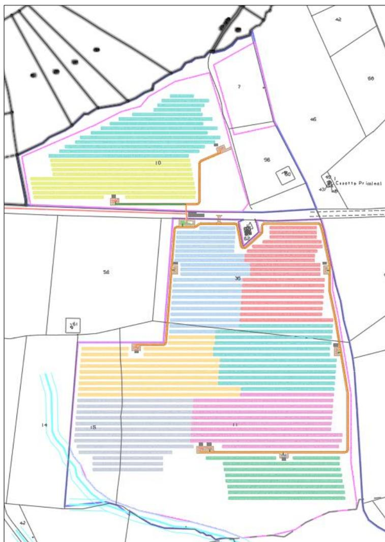
**Figura 2: Layout Cavi MT interno impianto FV**
