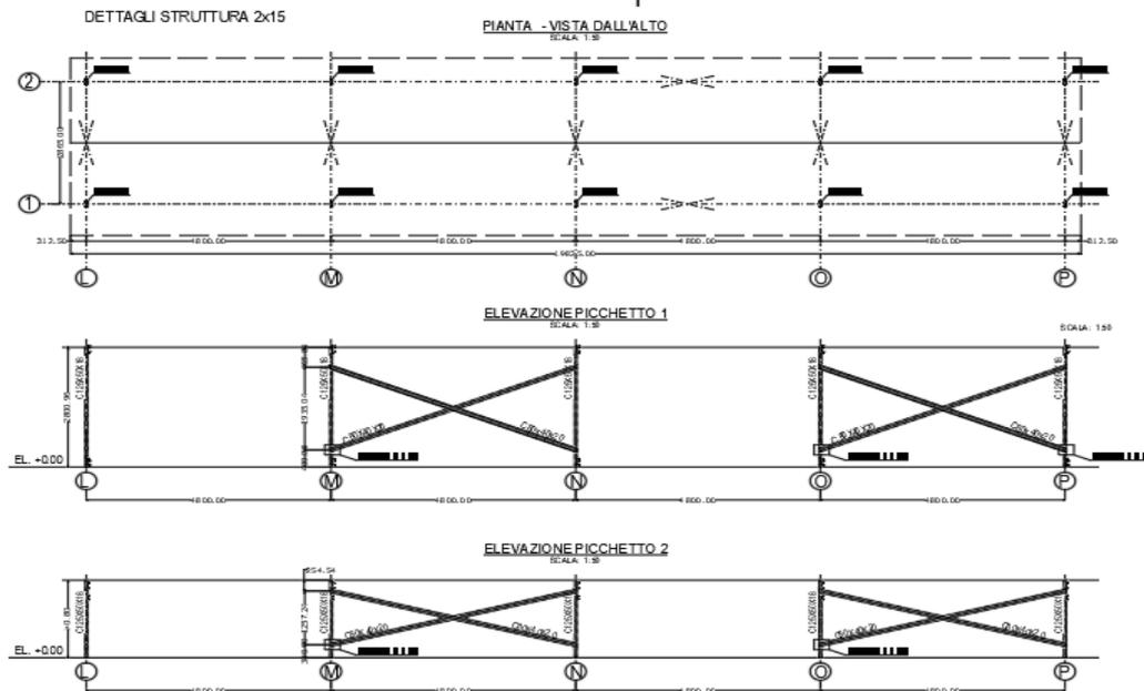
Figura 31: Configurazione Struttura Portamoduli 2x15
