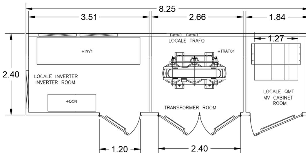
Figura 35: Rappresentazione della cabina di trasformazione - 2000 kVA.
