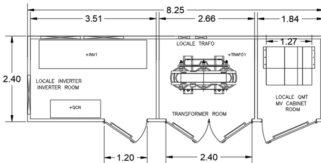
Figura 36: Rappresentazione della cabina di trasformazione - 1500 kVA
