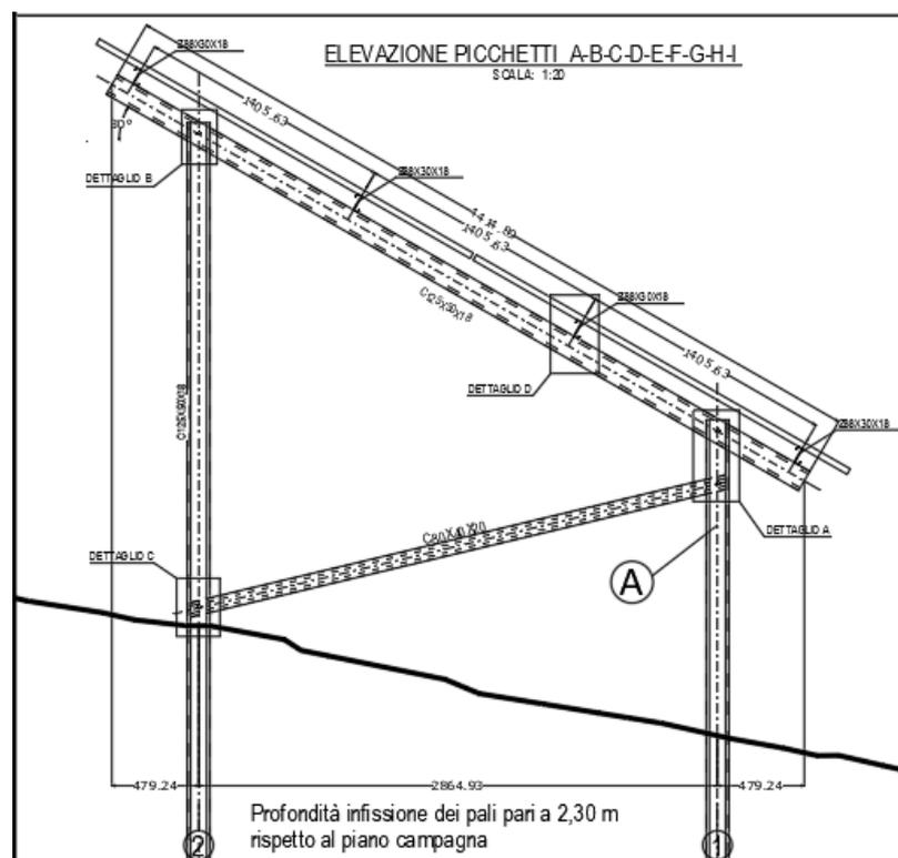
Figura 32: Sezione tipo Struttura Portamoduli
