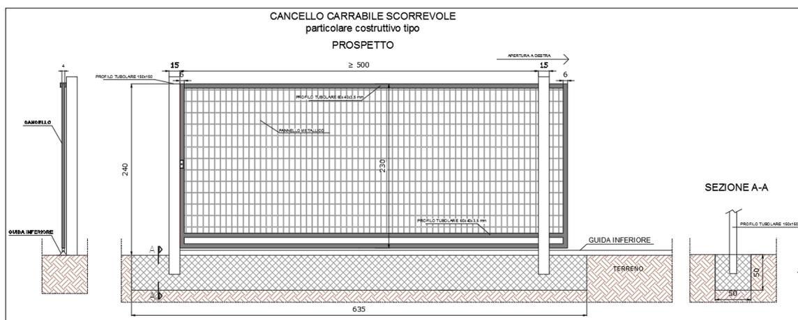
Figura 33: Cannello carrabile scorrevole (rif. doc. allegato al progetto)
