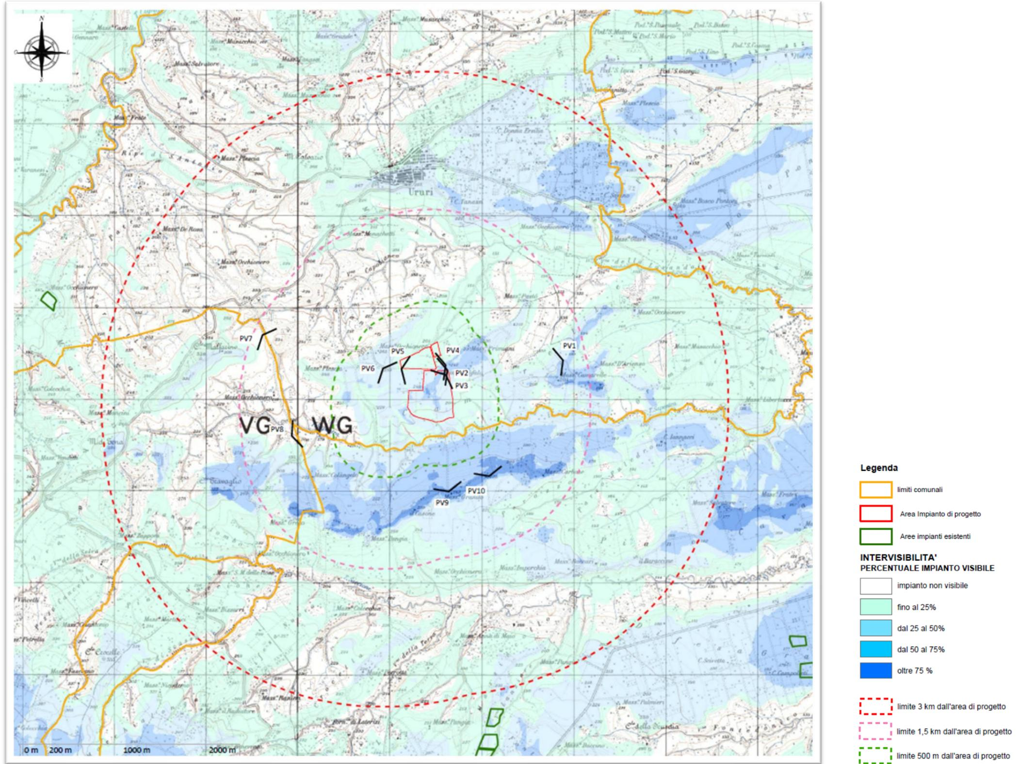
Figura 91: carta d'intervisibilità cumulativa dell'impianto fotovoltaico in progetto
