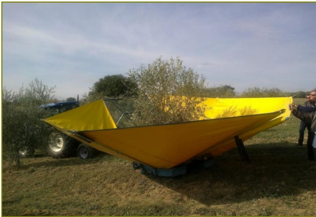
Figura 22 - Raccolta meccanizzata con braccio vibratore e telaio intercettatore ad ombrello rovesciato.
