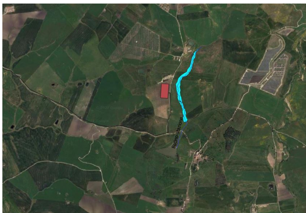
Figura 13 - Individuazione zone di inondazione con sovrapposizione dell’area di interesse – Stazione di rete
