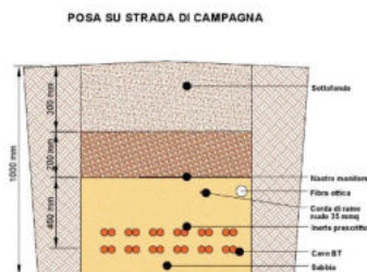
Fig. 30 – Sezione tipo-posa cavi BT
