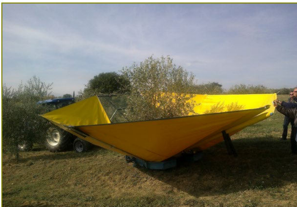
Figura 34 - Raccolta meccanizzata con braccio vibratore e telaio intercettatore ad ombrello rovesciato.
