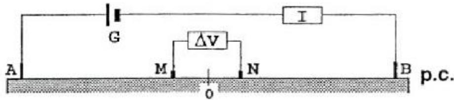
Figura 8.2 – Dispositivo di Schlumberger;  $MN = 1/5 AB$
