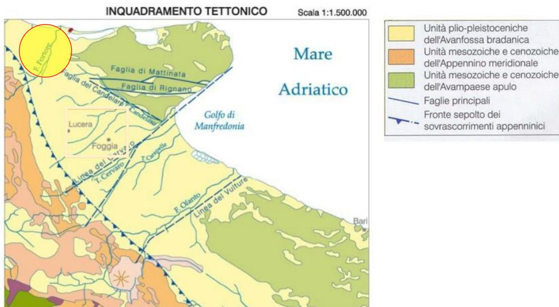
Figura 4.1: Schema geologico e strutturale dell'area del Tavoliere e del Subappennino Dauno.
