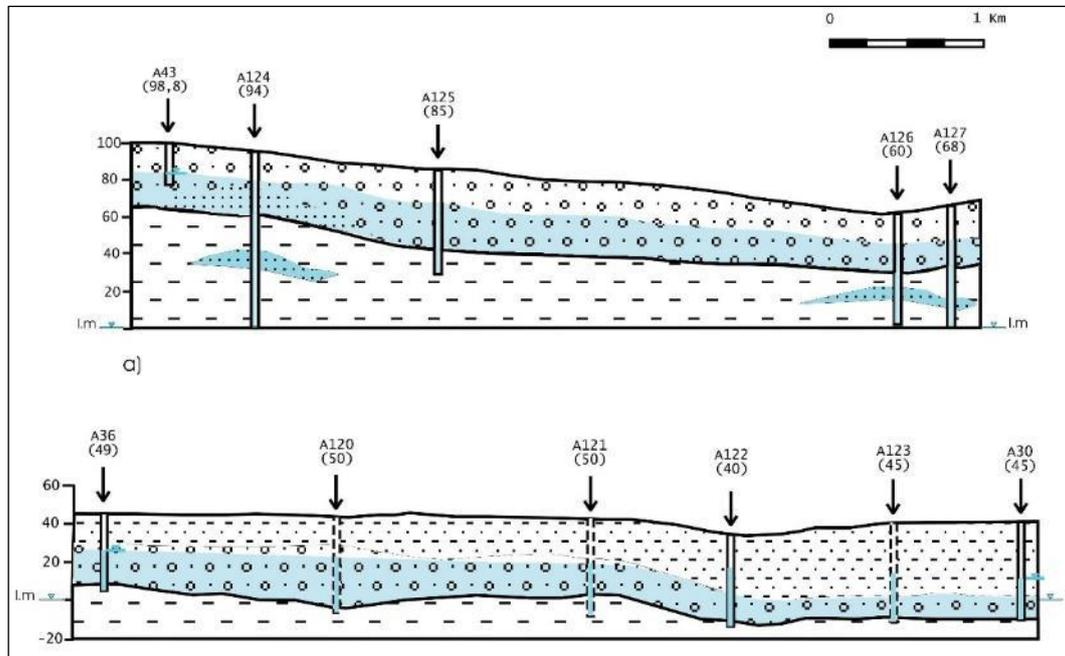
Figura 6.2 – Sezioni idrogeologiche. Legenda 1) Depositi d'alveo (Olocene); 2) depositi della pianura alluvionale (Olocene – Pleistocene sup.); 3) argille grigio-azzurrognole con intercalazioni sabbiose (Pleistocene inf. – Pliocene sup.) 4) Calcarenite (Pliocene sup. – Miocene); calcari della piattaforma carbonatica apula (Cretaceo); 6) Conoidi detritiche (Olocene – Pleistocene sup.) 7) Pozzo (in tratteggio, se proiettato).
