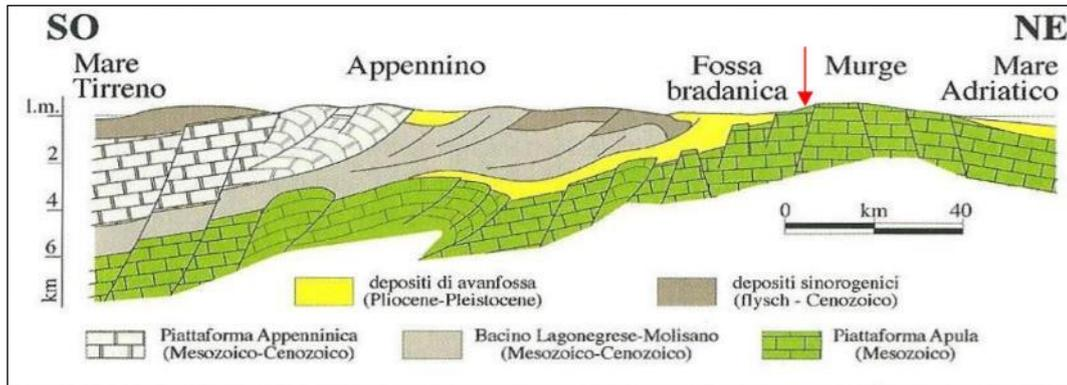
Figura 2.4 Sezione geologica schematica attraverso l'avanfossa appenninica.
