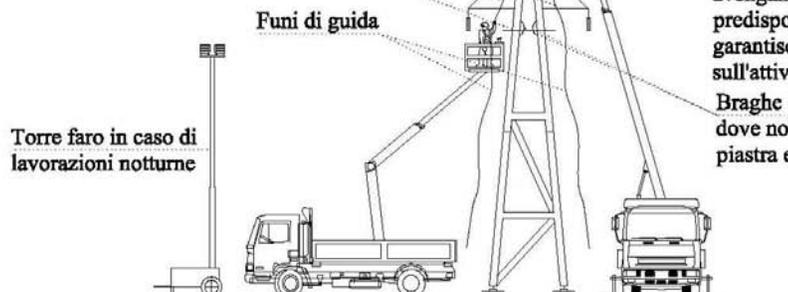
Prima di effettuare le operazioni di sbullonatura bisogna predisporre delle funi guida per la posa a terra della parte di traliccio.
