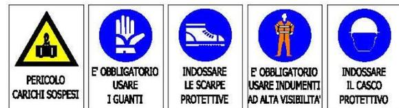
L'operatore addetto all'assistenza a terra alle macchine di sollevamento non deve sostare sotto il raggio di azione del braccio elevatore e potrà avvicinarsi ai carichi solo a movimentazione avvenuta, per lo sgancio delle funi o catene di sollevamento.
