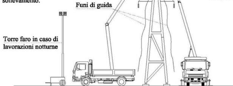
I lavoratori che andranno ad operare all'interno del cestello elevatore dovranno essere dotati e formati all'utilizzo delle cinture anticaduta; queste dovranno essere agganciate alla struttura del cestello ogni qualvolta si abbia l'esigenza di andare ad operare in quota.
