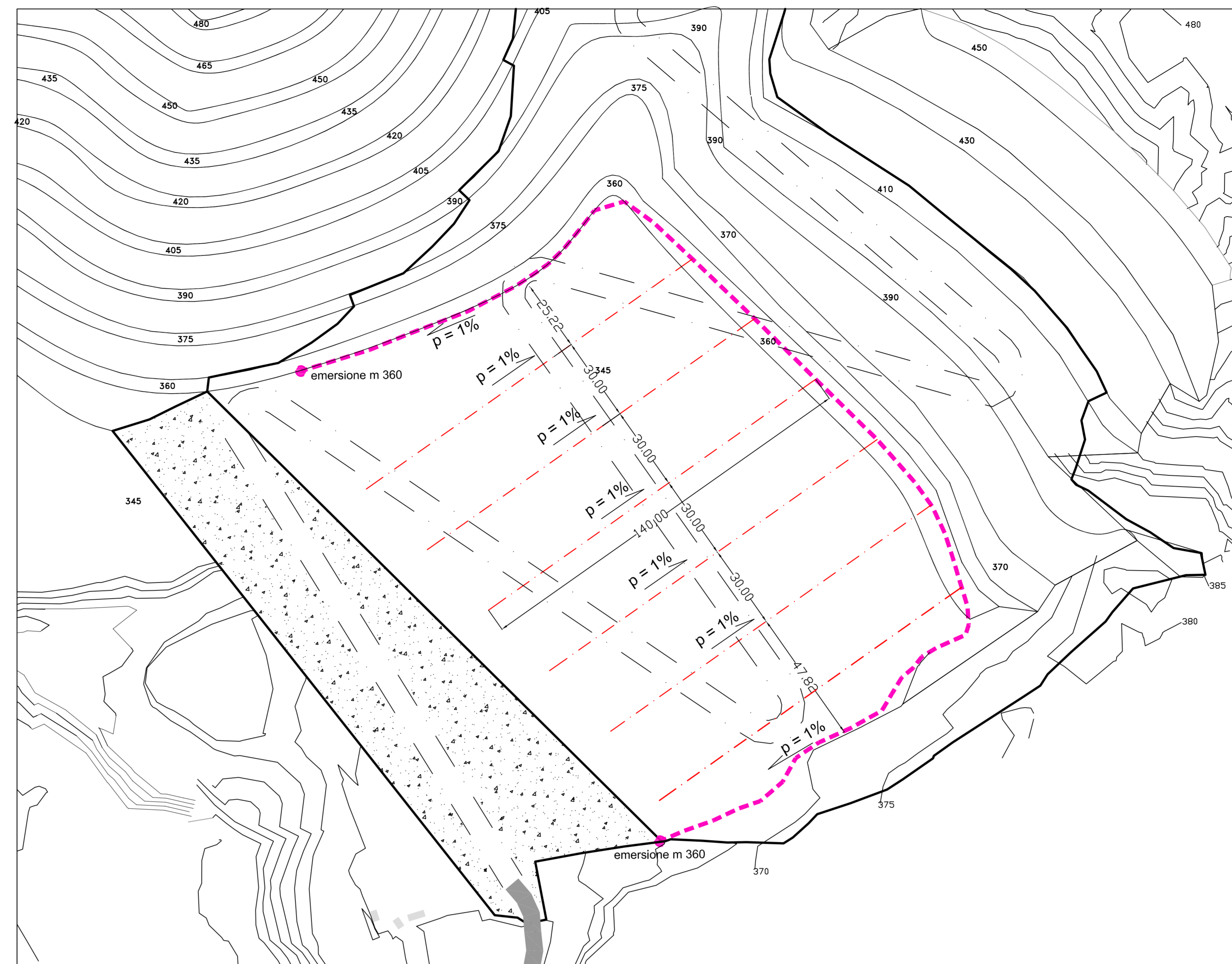
SISTEMA DI DRENAGGIO A QUOTA M 360 S.L.M
