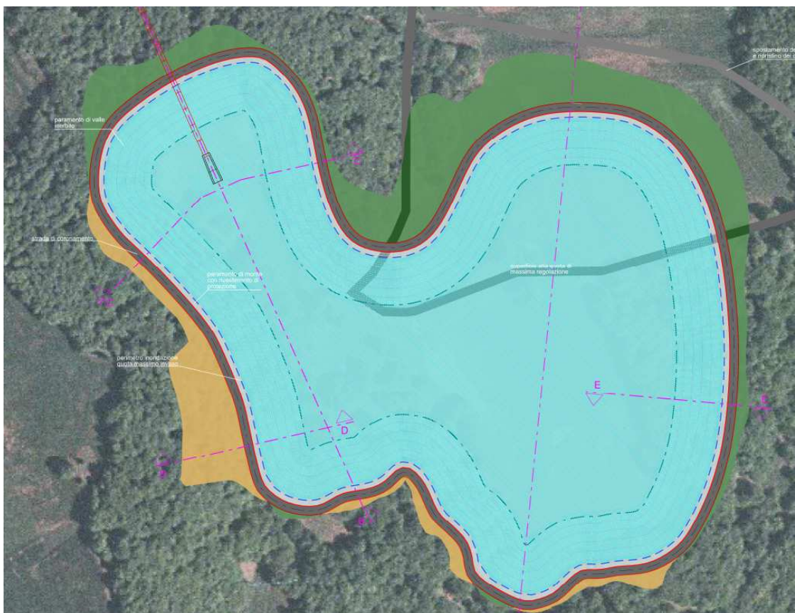
Figura 2. Planimetria di progetto dell'invaso di monte (estratto Tavola PD-EP.17).
