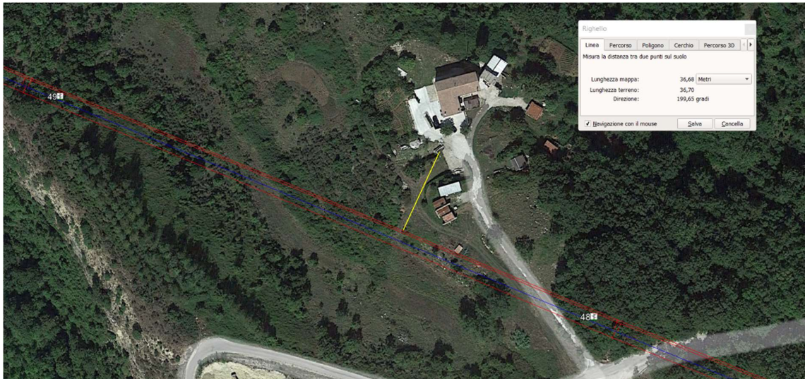
Figura 1 – Distanza tra cisterna GPL e proiezione dei conduttori a terra (distanza prescritta: 15 m)
