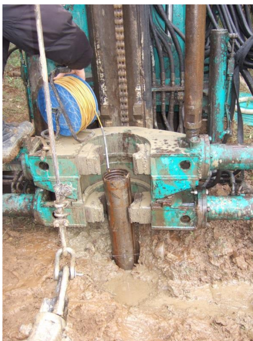
Figura 15: Fase di esecuzione della prova in foro tipo Lefranc
