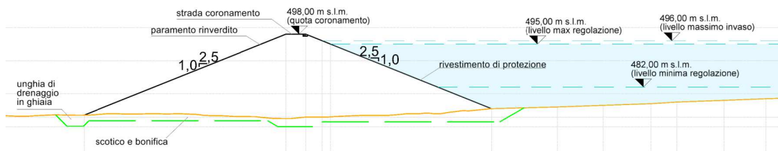
Figura 39. Sezione tipologica delle arginature dell'invaso di monte (estratto Tav. PD-EP.22.2).
