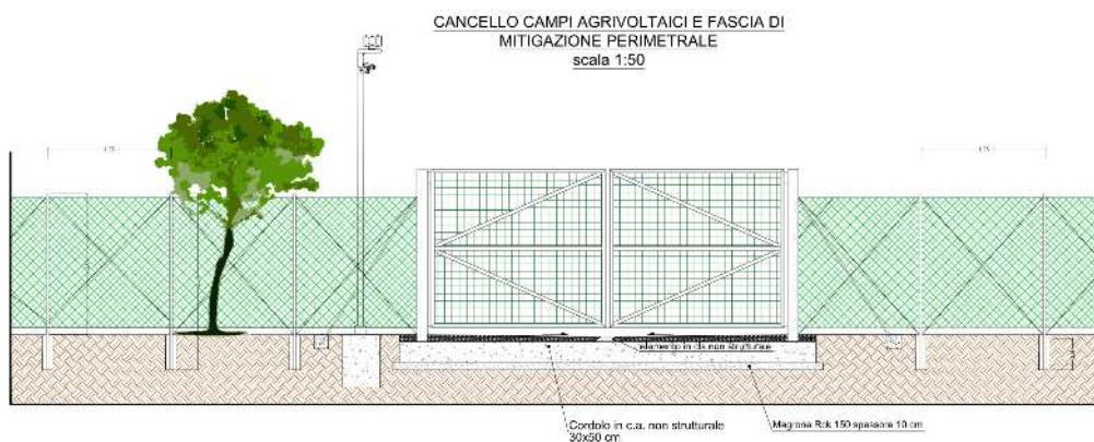
Figura 57 - Cannello di cantiere. (Fonte: ns elaborazione)
