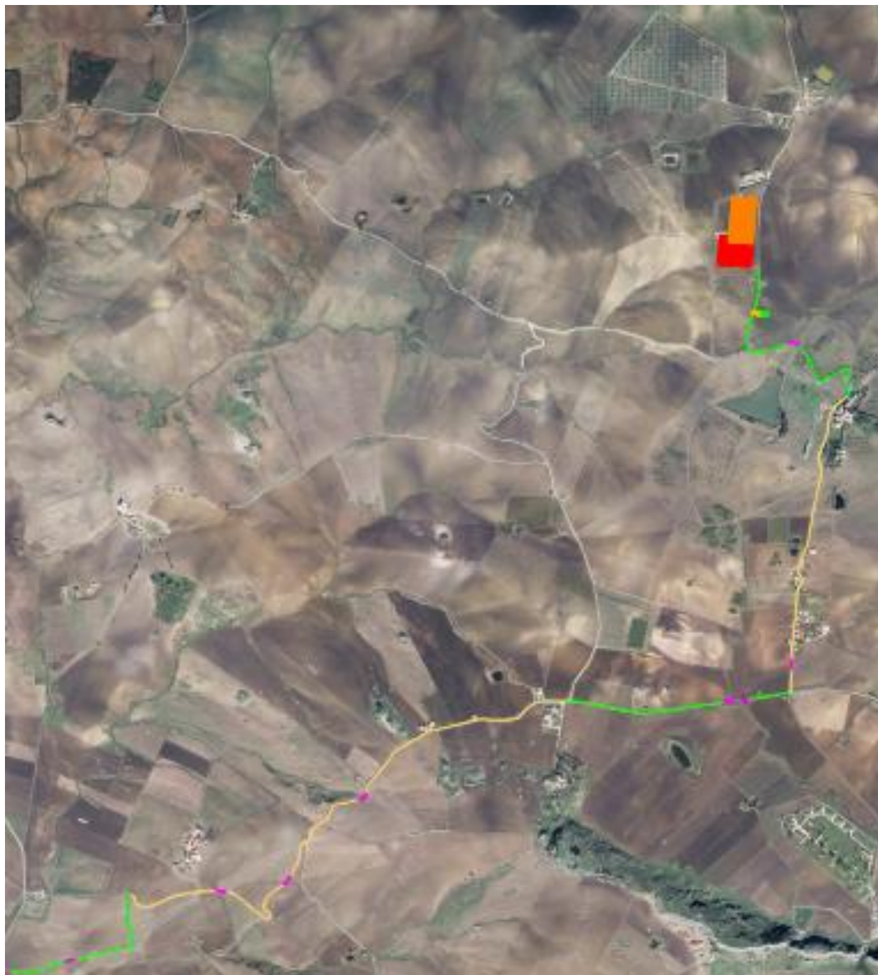
Figura 3-1 – Percorso cavi 36 kV
