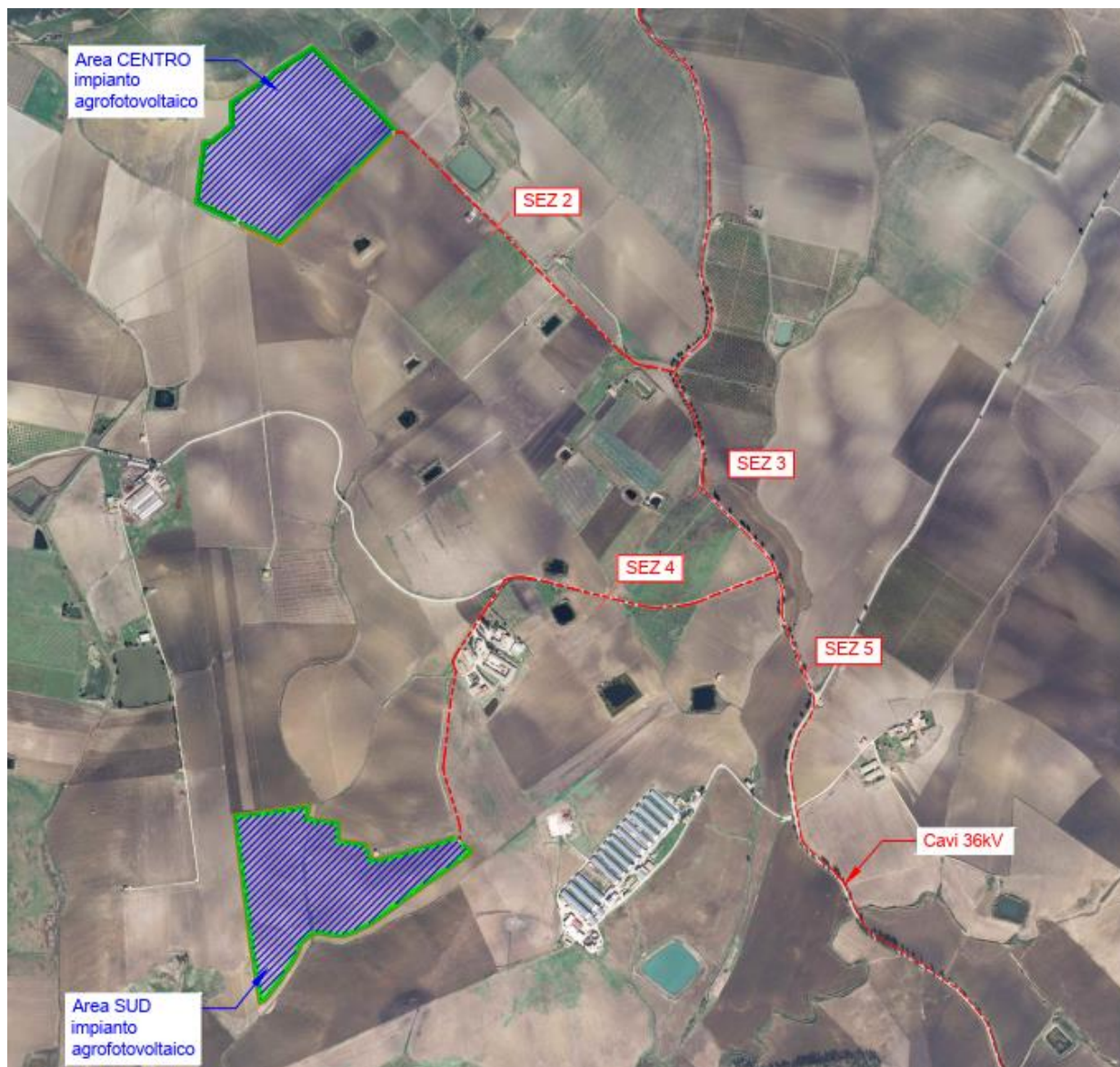
Figura 6-1 – Sezioni per definizione campo magnetico cavi 36 kV
