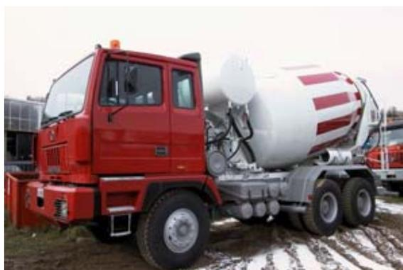
**Fig. 8.6.C Esempio di autotelaio con betoniera da circa 265 kW**
