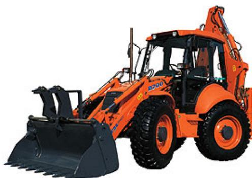
**Fig. 8.6.B** Esempio di terna da circa 80 kW
