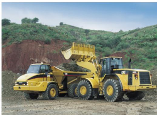
**Fig. 8.6.A** Esempio di pala meccanica da circa 200 kW
