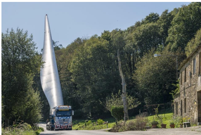
Figura 5– Blade lifter, utilizzato per il trasporto di pale per aerogeneratori
