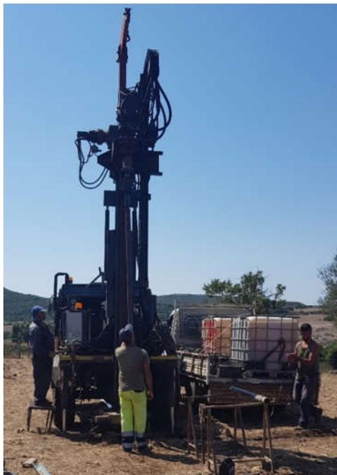
Figura 12 Sonda idraulica Hydra mod. Joy3
