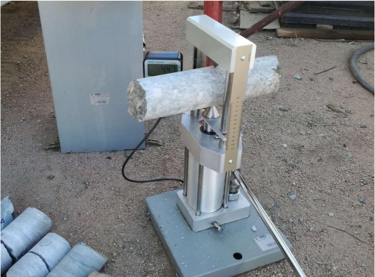
Figura 27 Esecuzione delle prova Point Load
