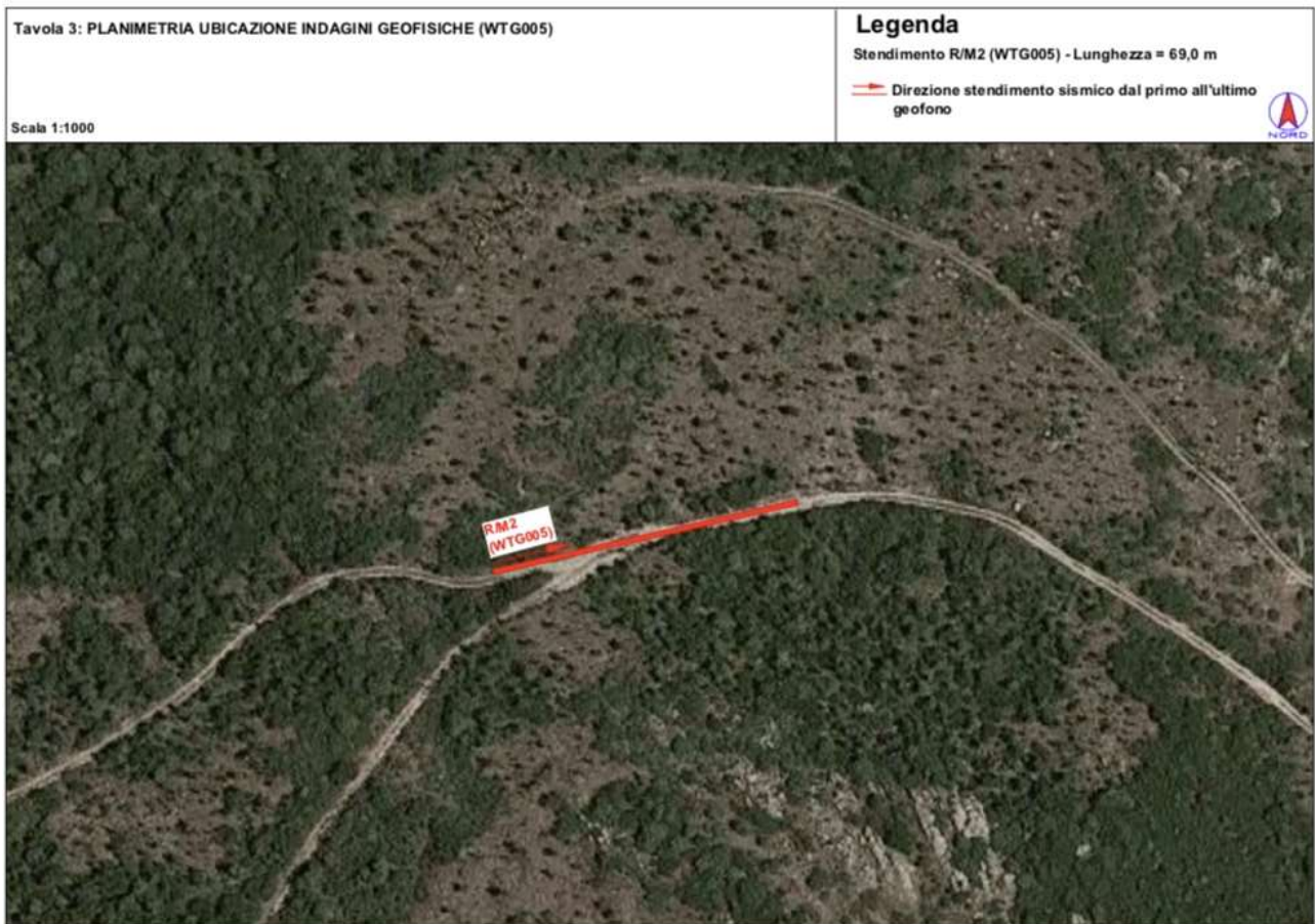
Figura 25: Ubicazione di dettaglio dello stendimento M2–R2
