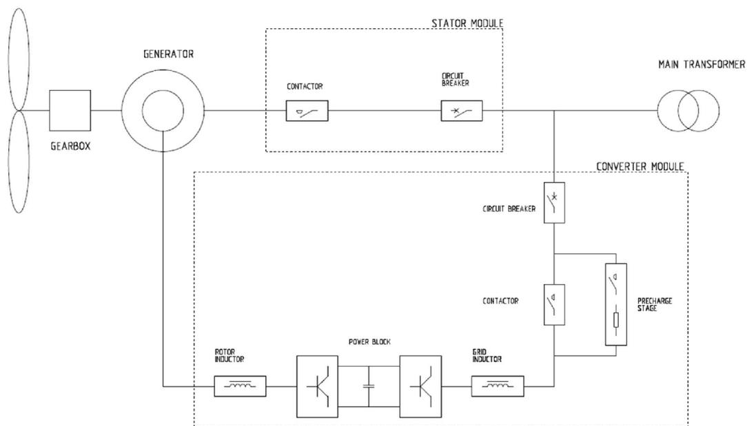
Tutte le apparecchiature necessarie alla trasformazione dell'energia meccanica del vento in energia elettrica sono dislocate nella navicella posta a 135 m di altezza. Nella figura che segue sono descritti i principali componenti presenti all'interno della navicella.
