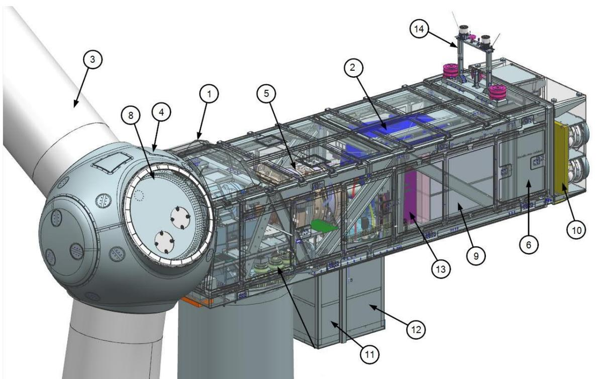
I principali componenti elettrici presenti all'interno della navicella sono l'alternatore e il trasformatore.
