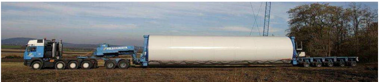
Foto 3 – Trasporto modulo torre
