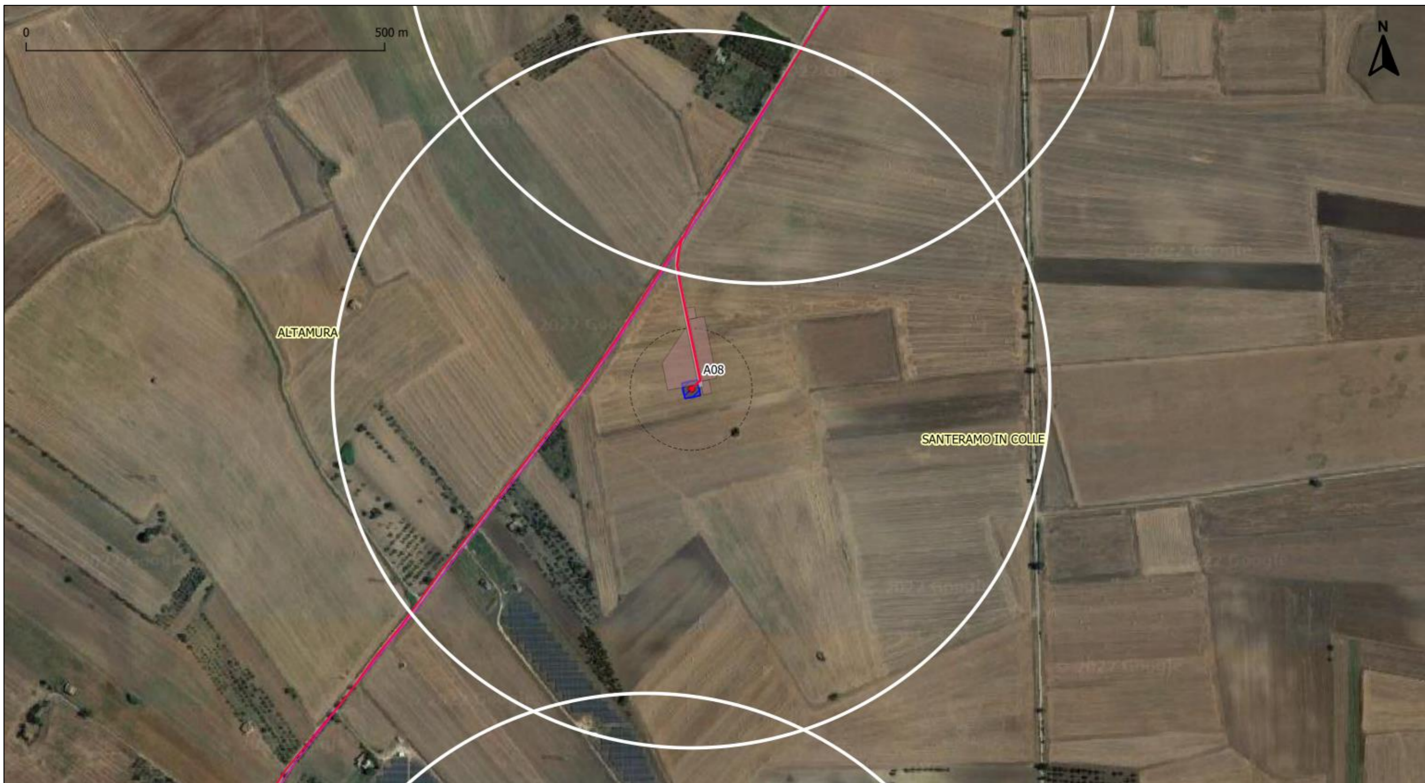
Ricettori nell'area buffer di 500 m – Nelle vicinanze della WTG 8 non si riscontra la presenza di ricettori sensibili
