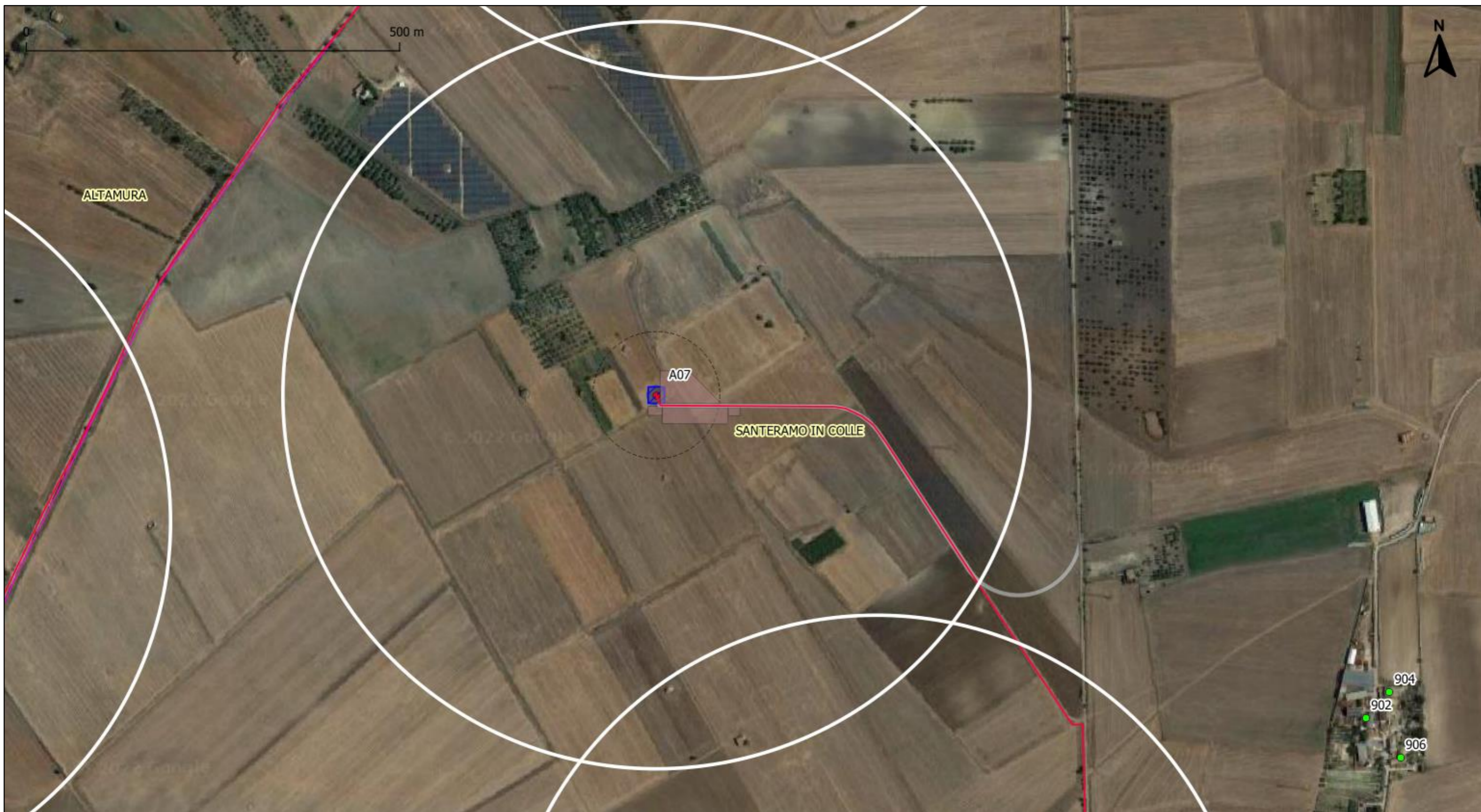
Ricettori nell'area buffer di 500 m – Nelle vicinanze della WTG 7 non si riscontra la presenza di ricettori sensibili
