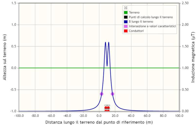
S3: una terna di conduttori di sezione 630 mm<sup>2</sup> disposti a trifoglio, percorse da corrente massima pari a 600 A ed interrata ad una profondità di 1,2 m
