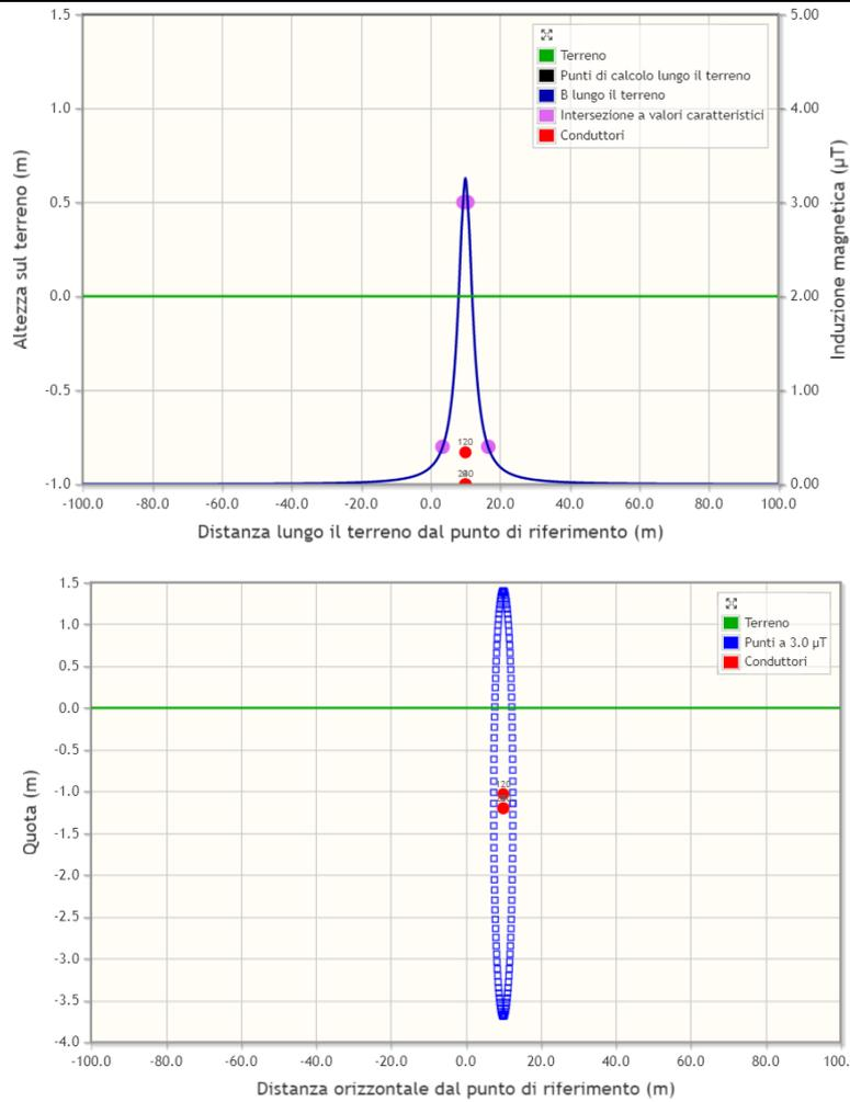
S2: due terne di conduttori disposti a trifoglio di sezione 240 mm<sup>2</sup> percorsa da corrente massima pari a 400 A per terna ed interrata ad una profondità di 1,20 m;
