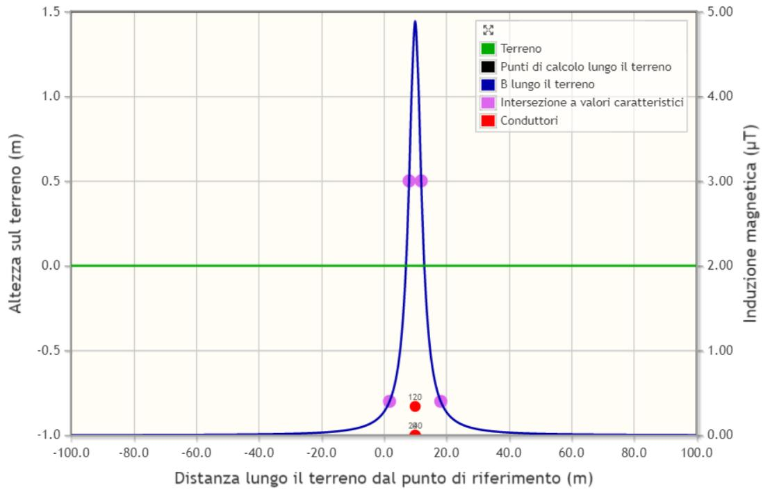
S5: una terna di conduttori di sezione 630 mm<sup>2</sup> ed una terna di sezione 240 mm<sup>2</sup>, disposti a trifoglio, percorse rispettivamente da corrente massima pari a 600 A e 400 A ed interrate ad una profondità di 1,2 m.
