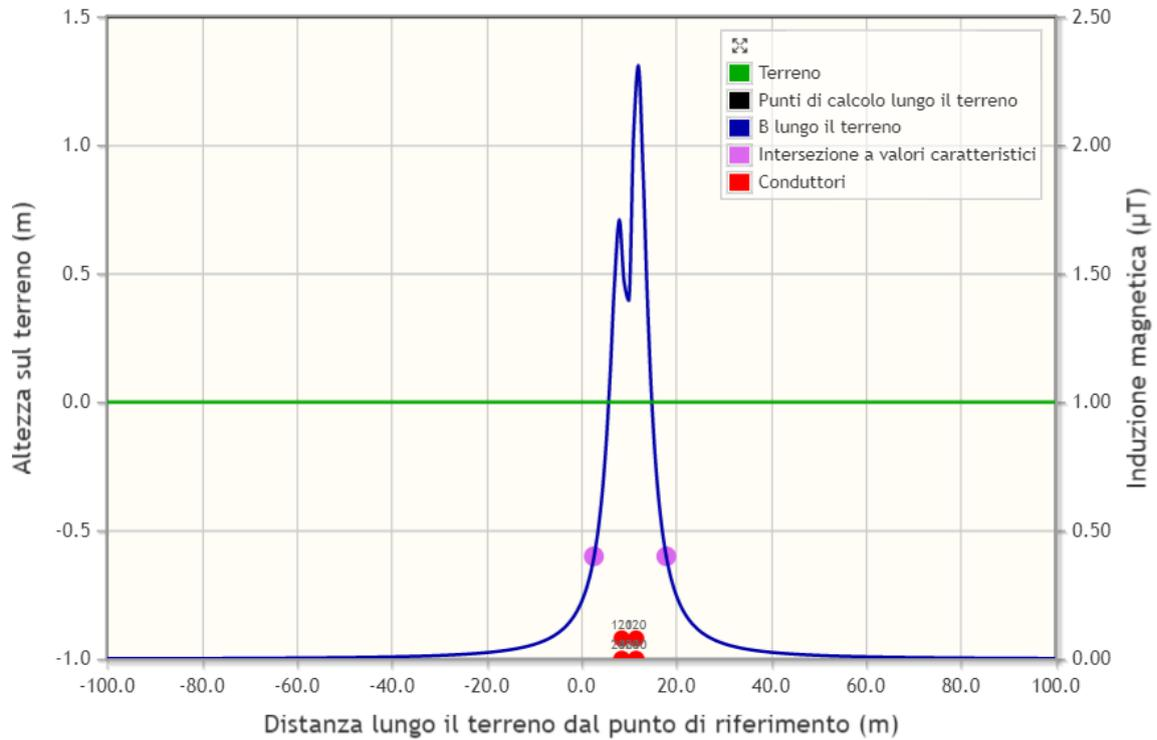
S6: una terna di conduttori di sezione 630 mm<sup>2</sup> ed tre terne di sezione 240 mm<sup>2</sup>, disposti a trifoglio, percorse rispettivamente da corrente massima pari a 600 A e 400 A ed interrate ad una profondità di 1,2 m.
