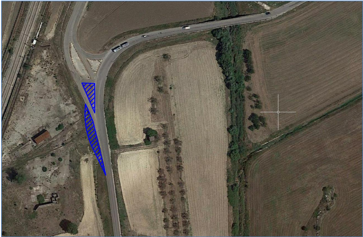
Intervento B – SP23 - Allargamento stradale
