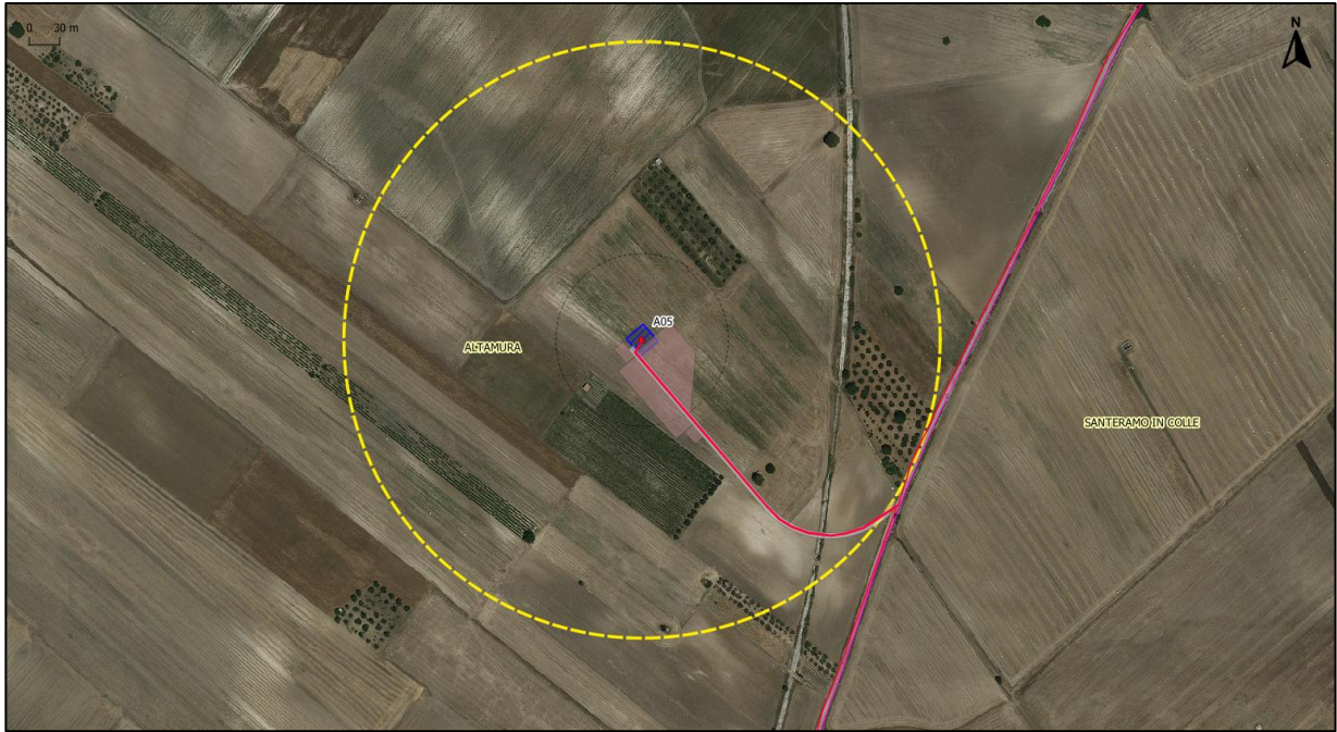
Buffer di 294 metri intorno alla WTG
