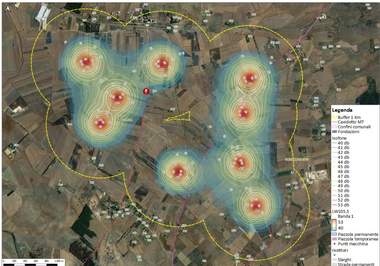
Risultati modellazione acustica – Isofone del livello di pressione sonora prodotto dall’impianto per LW 105,5 dB
