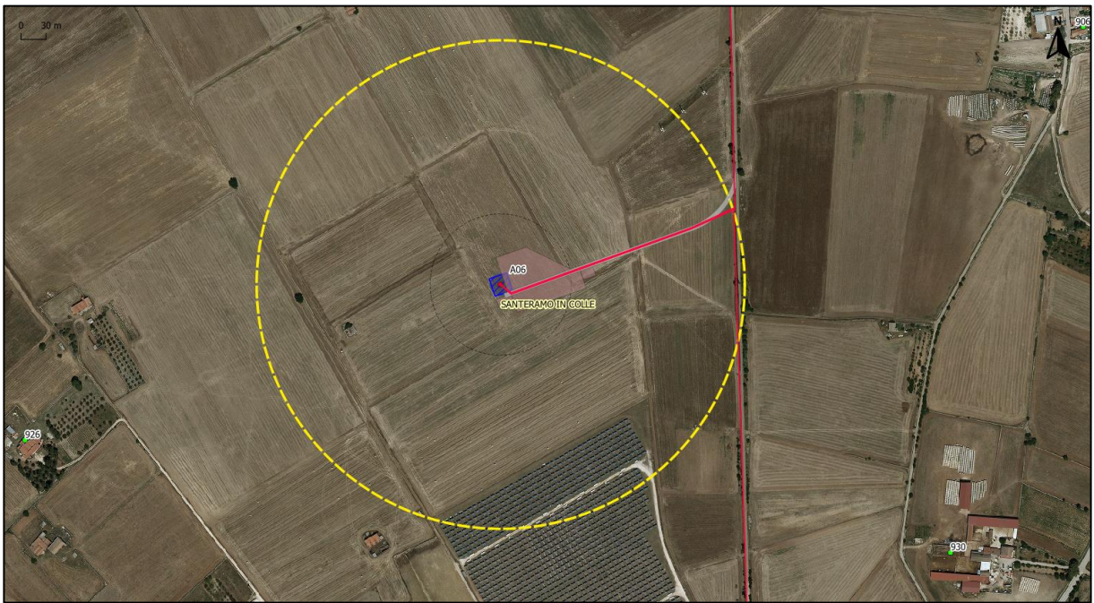
Buffer di 294 metri intorno alla WTG
