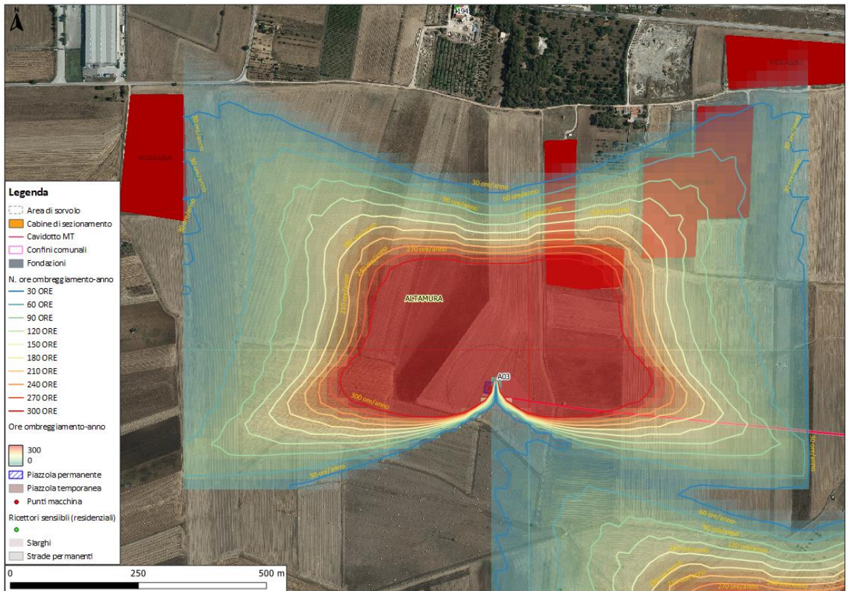
Nell'area di ombreggiamento della WTG 3, sono presenti più impianti fotovoltaici
