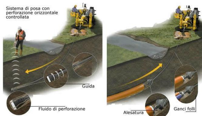
Fig. 1.2: Posa in opera tubazione per alloggio cavi
