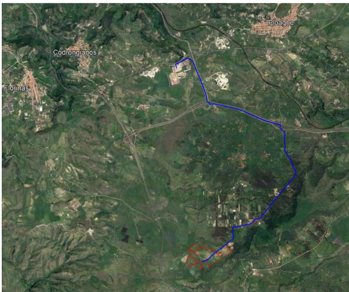
**Figura 1:** Ortofoto dell'area oggetto di studio. In rosso le aree di progetto, in blu il cavidotto.
