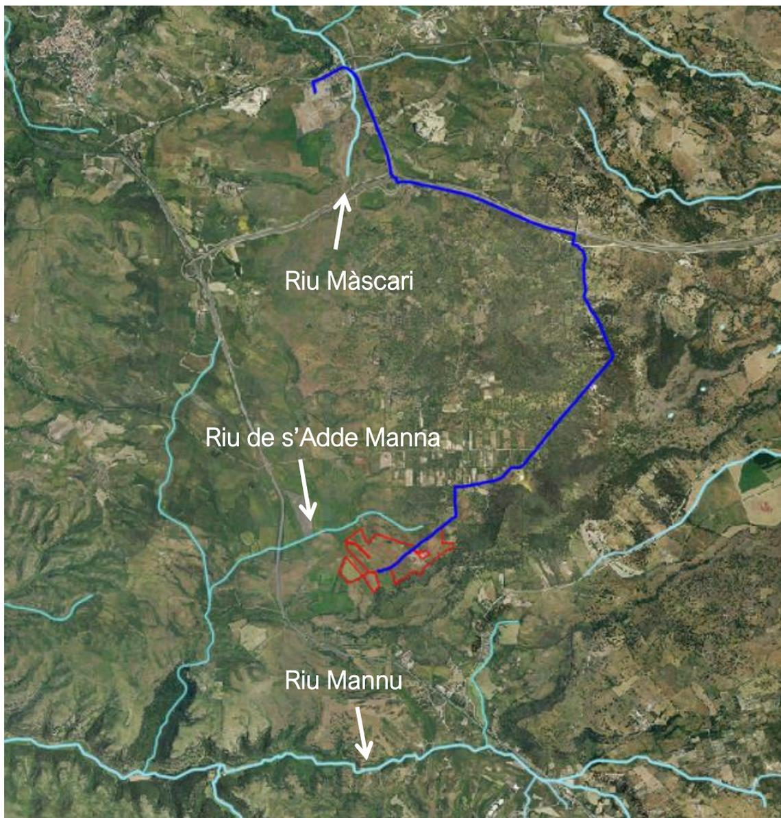
**Figura 2:** Collocazione delle aree di progetto rispetto i fiumi. In rosso le aree di progetto, in blu il cavidotto, in azzurro i fiumi presenti nell'area.
