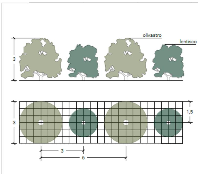
**Figura 3:** schema di impianto della fascia di mitigazione perimetrale.
