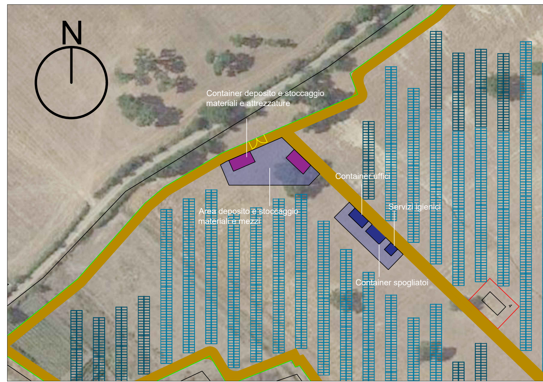
Particolare 1 aree cantiere - Scala 1:1000
