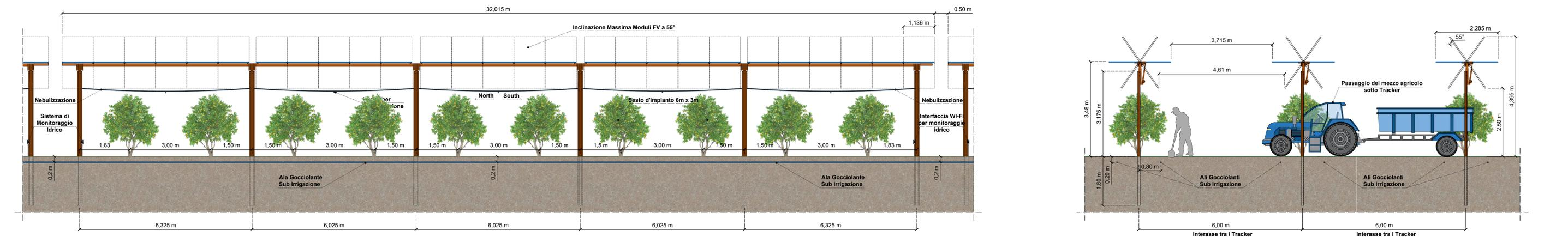
**Esempio di Prospetto e Sezione del Modello Tracker TRJ HT 1x27 - Integrato con Mandorleto e Sistema d'irrigazione e Monitoraggio idrico - SC. 1:50**
