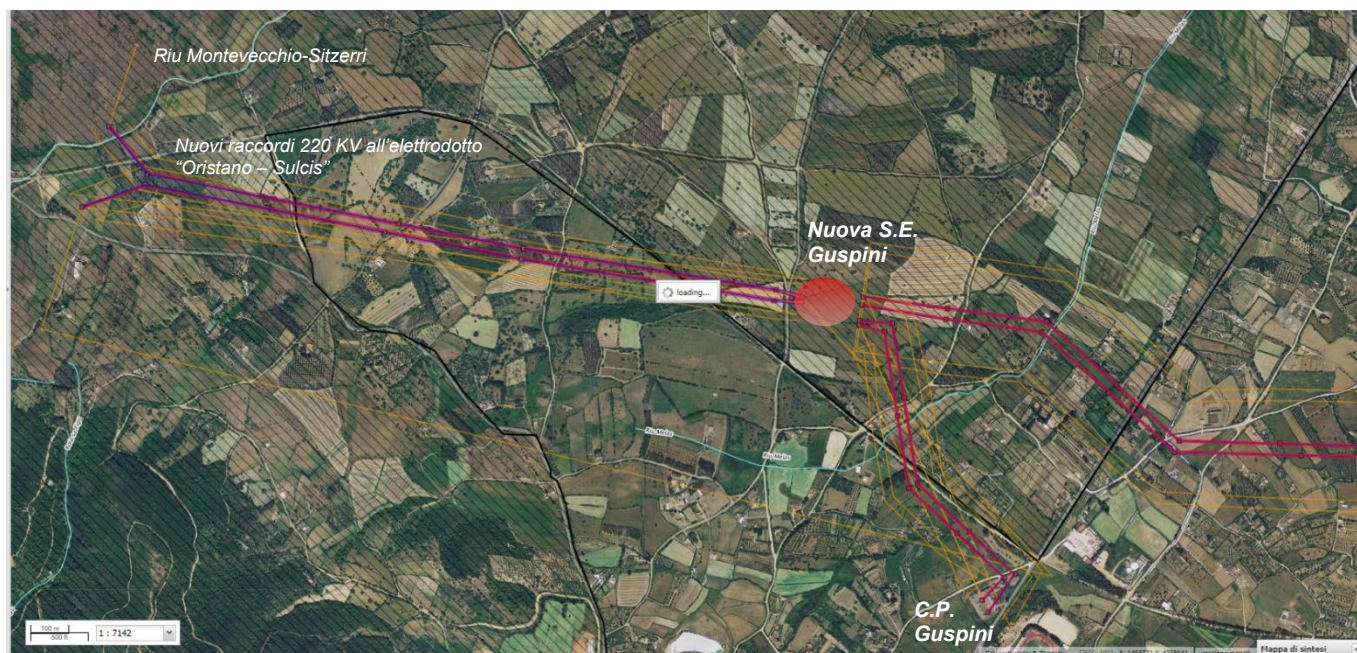
Figura 3 - Estratto Geoportale Sardegna, è evidenziata con retino nero l'Area dell'organizzazione mineraria, tutelata come bene identitario ai sensi del D. Lgs.42/04 art. 143. In tale area ricadono la nuova SE di Guspini, parte dei raccordi aerei a 220Kv e 150KV alla nuova S.E. e all'esistente C.P. di Guspini.
