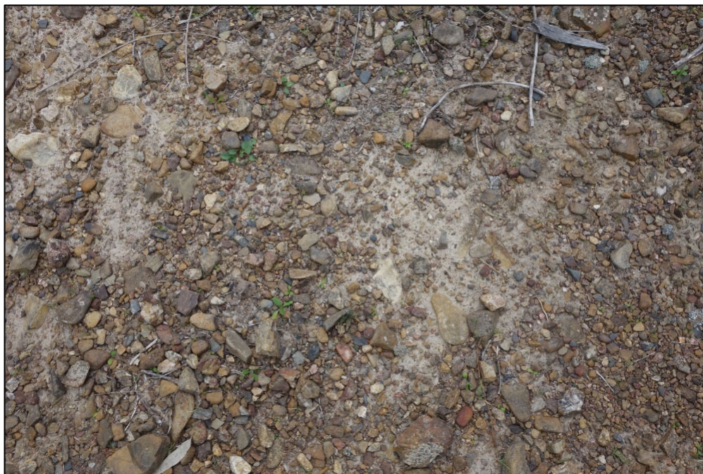
Figura 13: Particolare del terreno superficiale dell'area in esame. I clasti presentano una matrice a prevalenza argillosa.
