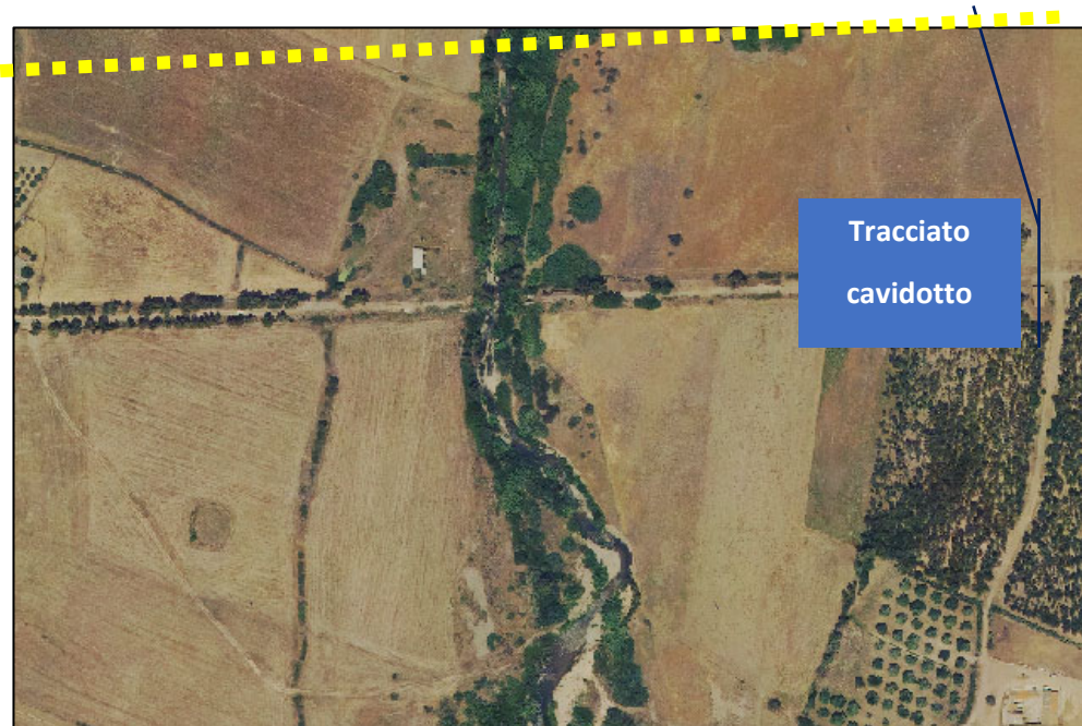
Figura 08: Tratto del tracciato del cavidotto con attraversamento del Riu Terra Maistus ed ubicazione della sezione descritta
