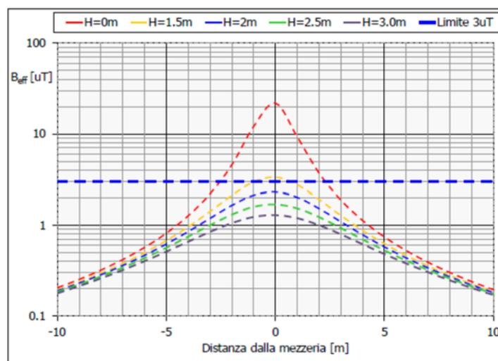
Si può osservare come nel caso peggiore il valore di  $3 \mu\text{T}$  è raggiunto a circa 2,6 metri dall'asse del cavidotto. Si può notare che la condizione di calcolo è ampiamente cautelativa, in quanto la corrente che fluirà nel cavidotto sarà quella prodotta da una porzione dell'impianto fotovoltaico, che, come detto, è pari a 286 A nelle condizioni di massima
