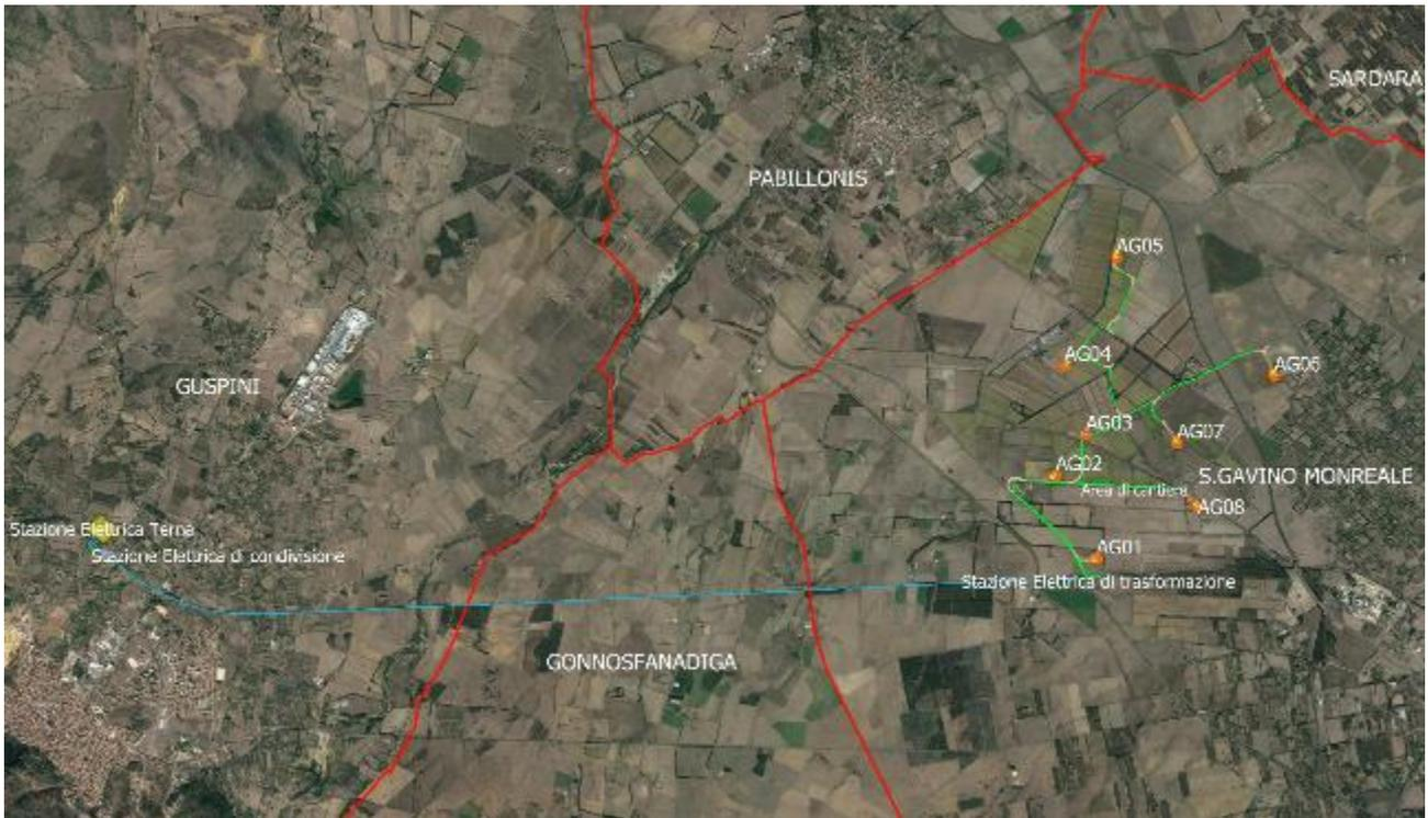
**Figura 6 - Sviluppo del cavidotto in MT (in verde) e di quello in AT (in azzurro)**
