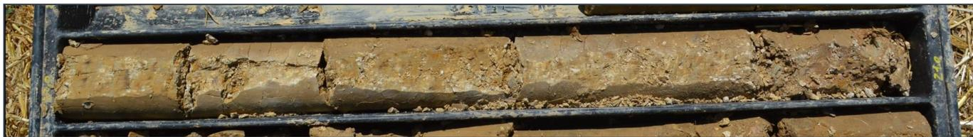
**Figura 4.2 – Ghiaie ciottolose in matrice limo-argillosa provenienti da un sondaggio eseguito in agro di San Gavino**
