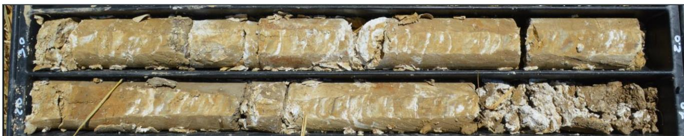
**Figura 4.3 – Argille limose carbonatiche provenienti da sondaggio eseguito in agro di San Gavino**
